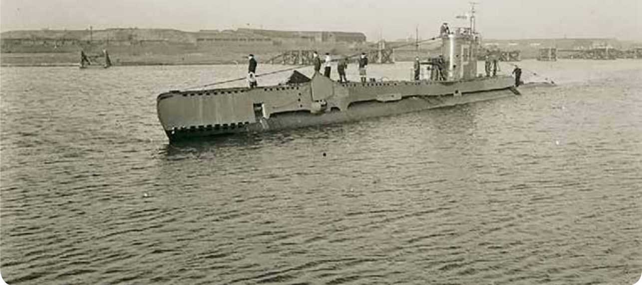
Okręt podwodny ORP „Dzik” (brytyjskiego typu „U”; widoczne złożone stery głębokości)
