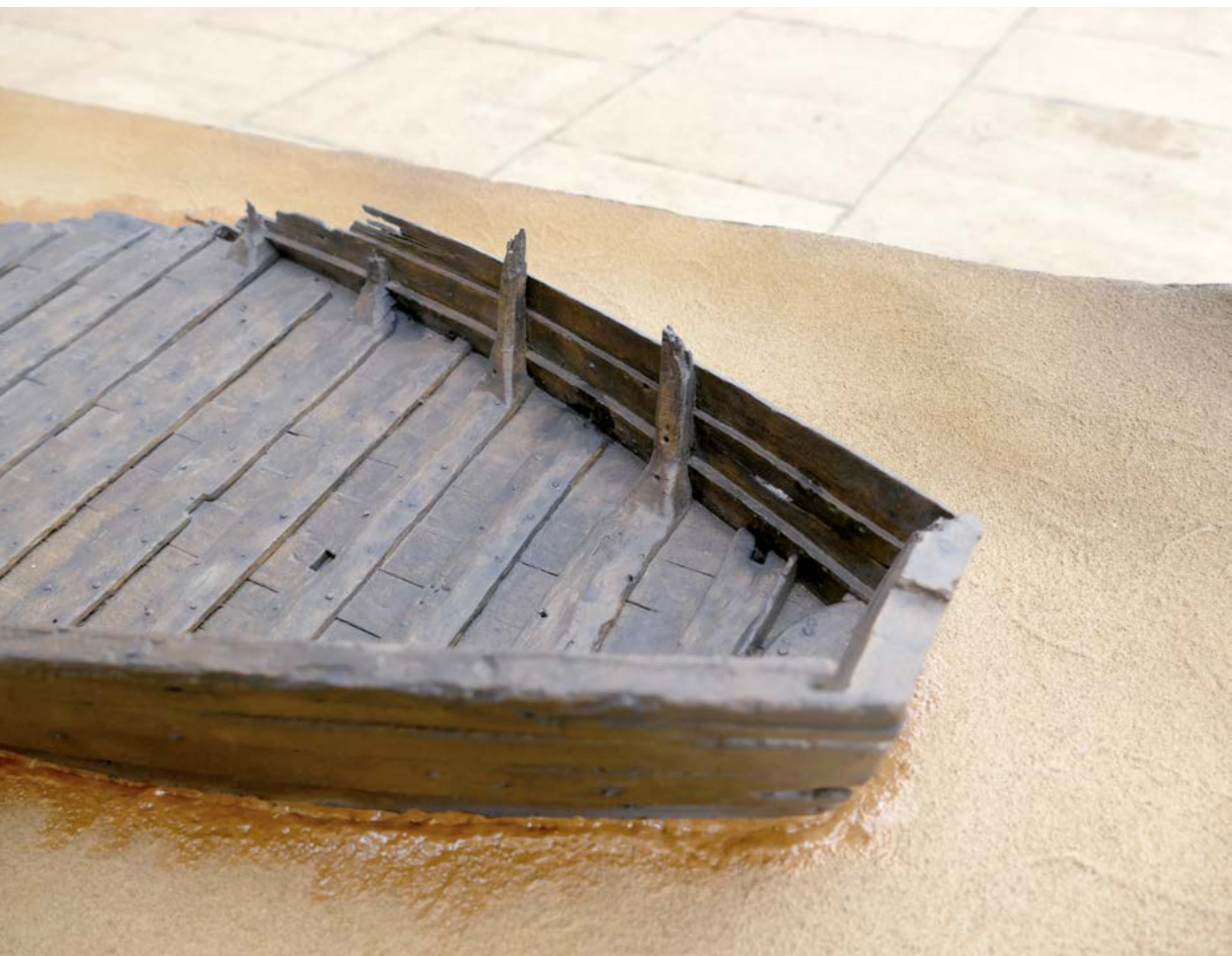
Ryc. 29. Fragment modelu w skali 1:20 szkuty z czerska wykonanego z wydruku 3D na podstawie sporządzonej dokumentacji cyfrowej. Autor J. Borkowski.
