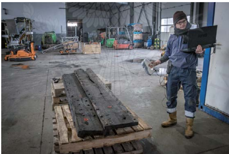
Ryc. 26. Dokumentacja elementów szkuty wykonywana przy użyciu ręcznego skanera 3D. Fot. M. Grabowski.
