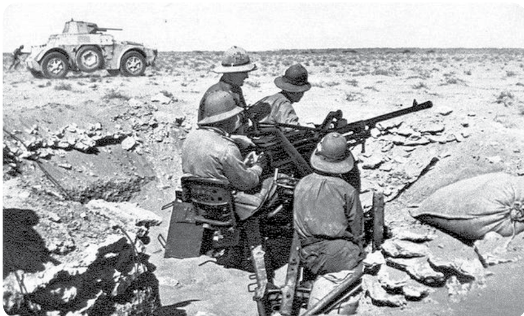
Na pierwszym planie włoska „Breda” na stanowisku obronnym gdzieś na Pustyni Libijskiej. Na drugim planie wspierający działon samochód pancerny AB 41 wyposażony w to samo działko „Breda” 20 mm
